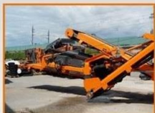
HYDRAULICZNIE OPUSZCZANA SKRZYŃIA PRZESIEWAJĄCA ORAZ GŁÓWNY TAŚMOCIĄG
